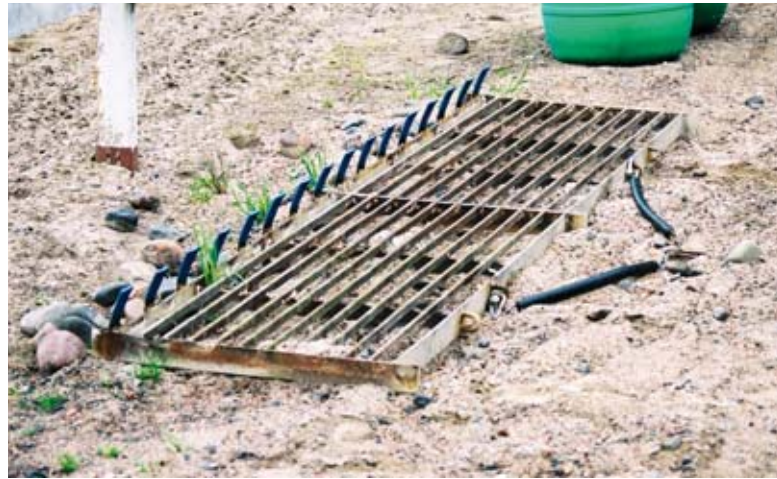
Halpa ja kätevä kentän lana: Vanhasta navetan lantaritilästä tehtynä, johon on hitsattu kiinni äestävät piikit.
