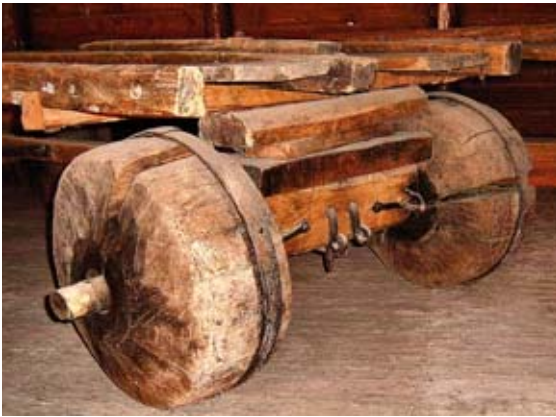
Puupölkkypyörillä ja puuakselilla varustetut nelipyörävankkurit Viron Maatalousmuseossa Tarton Ülenurmella. Kuva Ilmari Kosonen.
