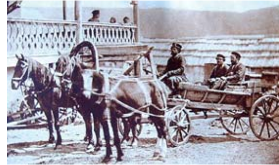
Työ- ja matkavankkurien korin perusrakenne oli hyvin kauan veneen malli. Kuvassa venäläiset tarantassi-vankkurit troikkavaljastuksessa yli 100 vuoden takaa. Kuva Sven Hedin 1901.
