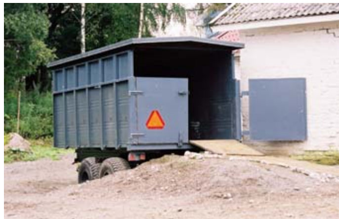
Traktorin peräkärryn päälle rakennettu kätevä pienlantala. Kuva Kari Vepsän tallilta.
