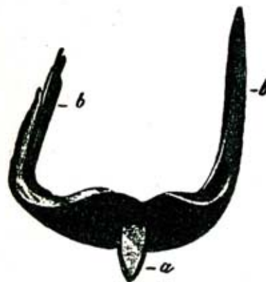
Viskari oli kavioon kiinteästi kiinnitetty hevosenkenkä, mutta epämukava hevoselle. Sitä käyttivät talvisin lähinnä kalastajat liikkuaan jäitä pitkin hevosillaan. Leuwenhaupt 1924.
